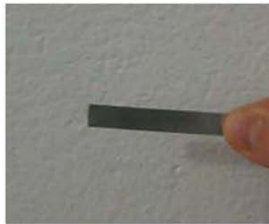
Figure II-3 : Forme initiale d'une lame d'épaisseur 0,3 mm
