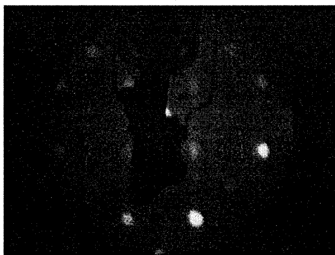
Figure E-3: Images de diffraction LEED obtenues sur un monocristal de MgO(001) bombardé et recuit à 800 °C pour différentes énergies des électrons incidents: (a) 70 eV, (b) 120 eV, (c) 170 eV.
