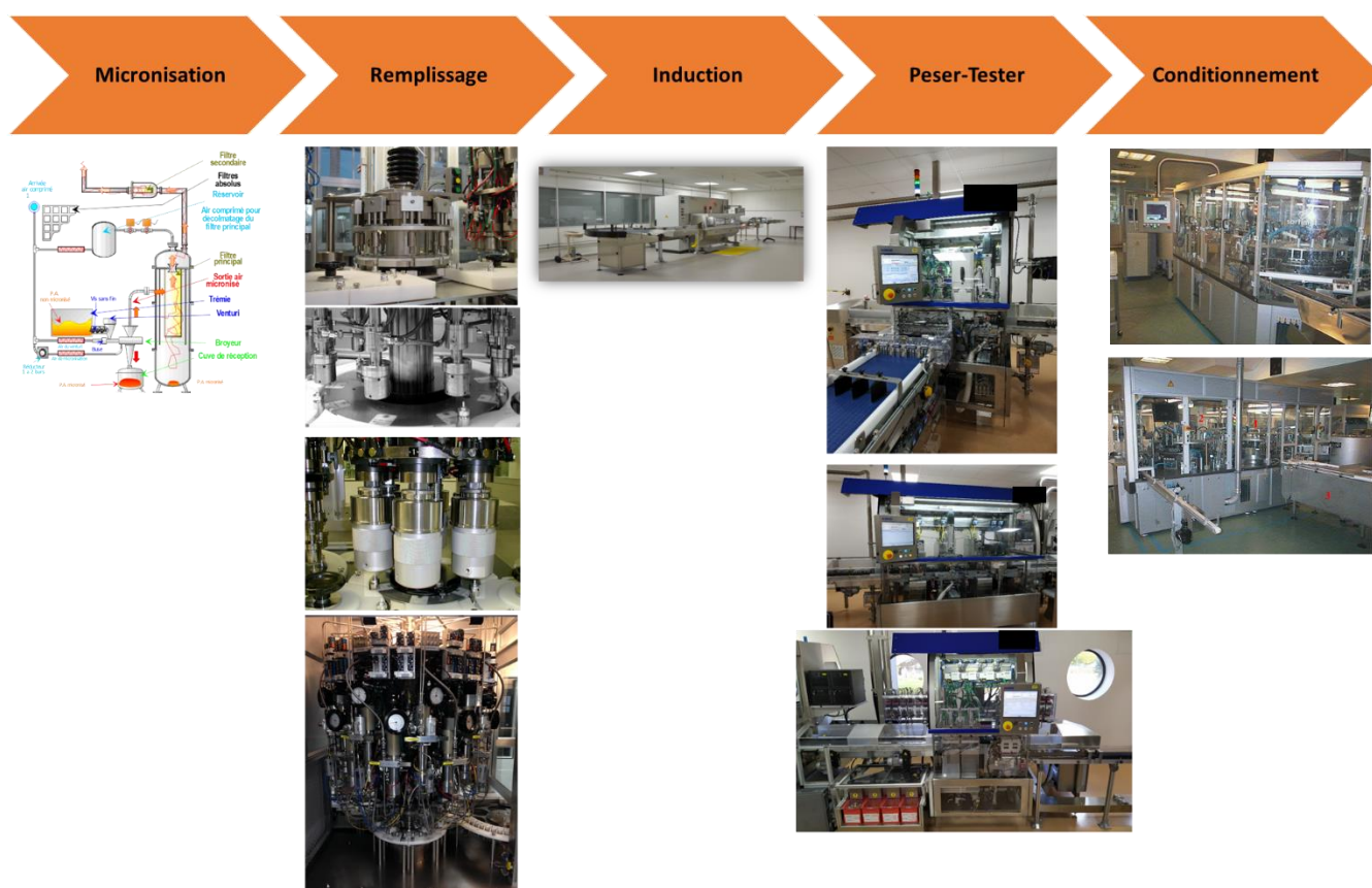
Figure 23. Les cinq étapes de production d'un aérosol sur le site de GSK Evreux
