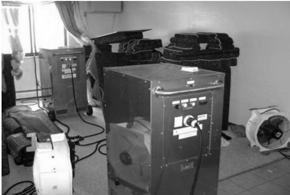
FIGURE 58 : TRAITEMENT THERMIQUE D'UNE PIÈCE ENTIÈRE AVEC UN GÉNÉRATEUR DE CHALEUR ÉLECTRIQUE (DOGGETT ET AL, ADVANCES IN THE BIOLOGY AND MANAGEMENT OF MODERN BED BUGS, 1ÈRE ÉDITION, JOHN WILEY & SONS ED. 2018)
