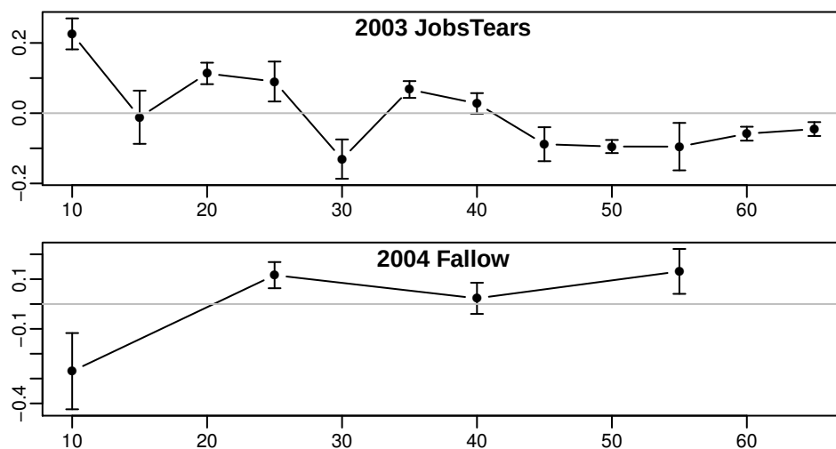
FIG. 4.18 – Déviation relative à la moyenne calculée sur le logarithmes des infiltrabilités en 2003 (Larmes de Jobs) et 2004 (Jachère) en fonction de la pente (%). Les barres indiquent l'intervalle de confiance de la moyenne à 90 %.
