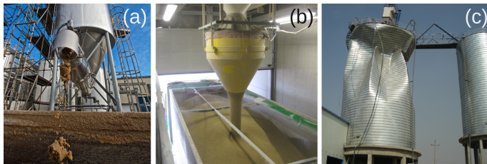
FIGURE 1.29 – (a) Vidange d'un silo rempli de sable cohésif formant des agrégats en sortie. (b) Solution technique permettant de limiter la formation de poussière lors de la vidange d'un silo surélevé (crédits : AGRO PROFF (DSH solution)). (c) Effondrement partiel d'un silo causé par un potentiel mauvais dimensionnement de celui-ci (crédits : Engineering Services Hamburg).
