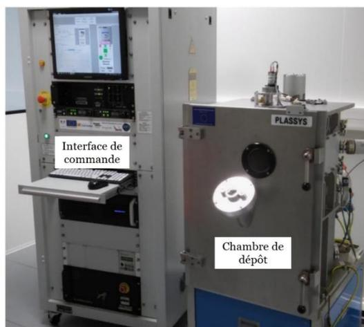
Figure 2.5 - Photographie du bâti d'évaporation utilisé
