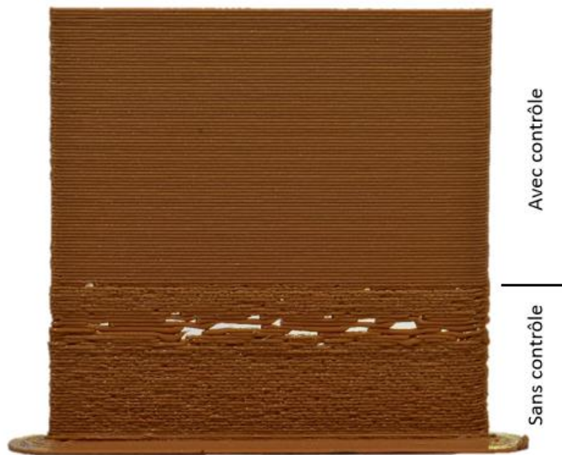
Figure 43 : Photographie d'un « wall » pour lequel la partie basse a été imprimée sans contrôle, et la partie haute avec contrôle par le produit
