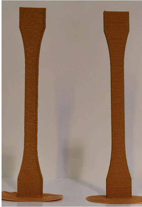
Figure 51 : Deux éprouvettes de traction imprimées à gauche sans contrôle, à droite avec contrôle
