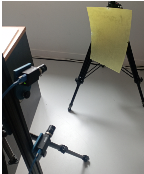
FIGURE 2.19 – Mesure par corrélation 3D d'images numériques des déformations liées au rétreint chimique dans un assemblage asymétrique.
