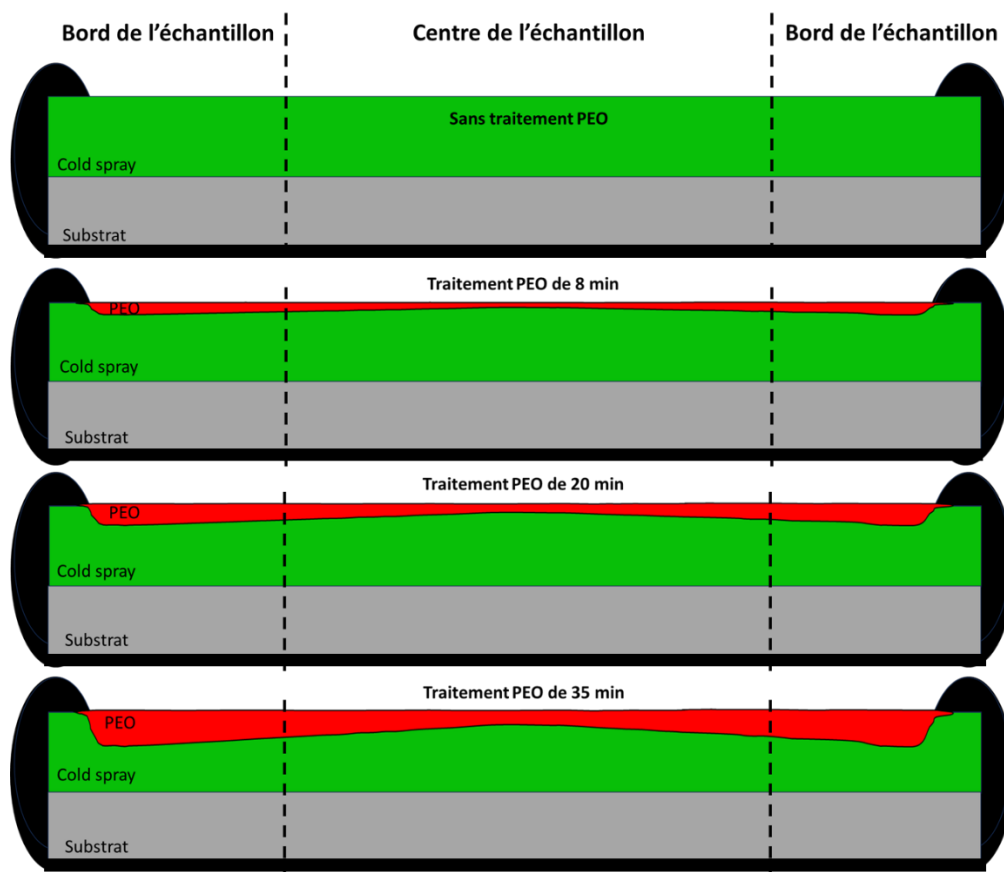
Figure 19 : Schémas de la croissance de la couche d'oxyde PEO sur un échantillon revêtu par cold spray puis poli en surface avant traitement PEO à différents temps de traitement.
