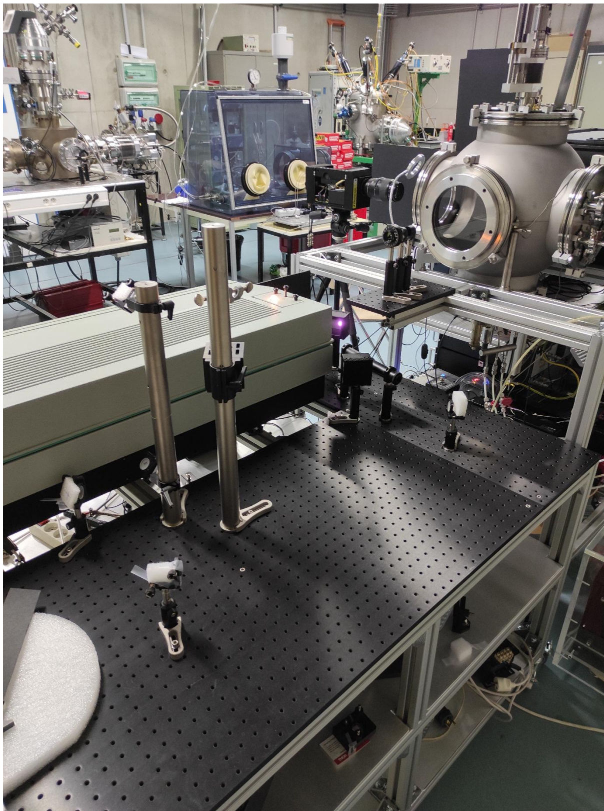
Photographie du réacteur servant à la mise en œuvre de la décharge iDBD. Apparaissent sur la photo : le banc optique servant à la mesure E-FISH, la camera iCCD rapide, l'enceinte et le système d'alimentation de la cellule iDBD.
