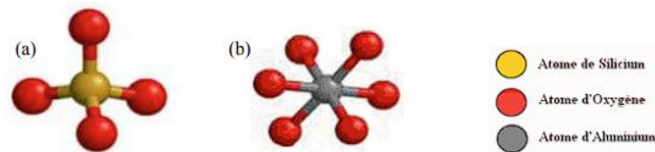
Figure 1-6 : Structure minérale de base des argiles : la structure tétraédrique (a) et la structure octaédrique (b) (Didier, 2012).
