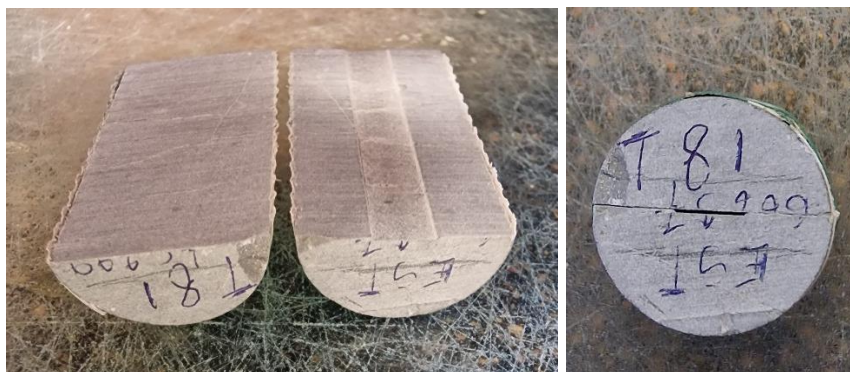
Figure 3-2 : Echantillon d'argilite du COx coupé en deux avec une face usinée pour l'essai d'auto-colmatage.
