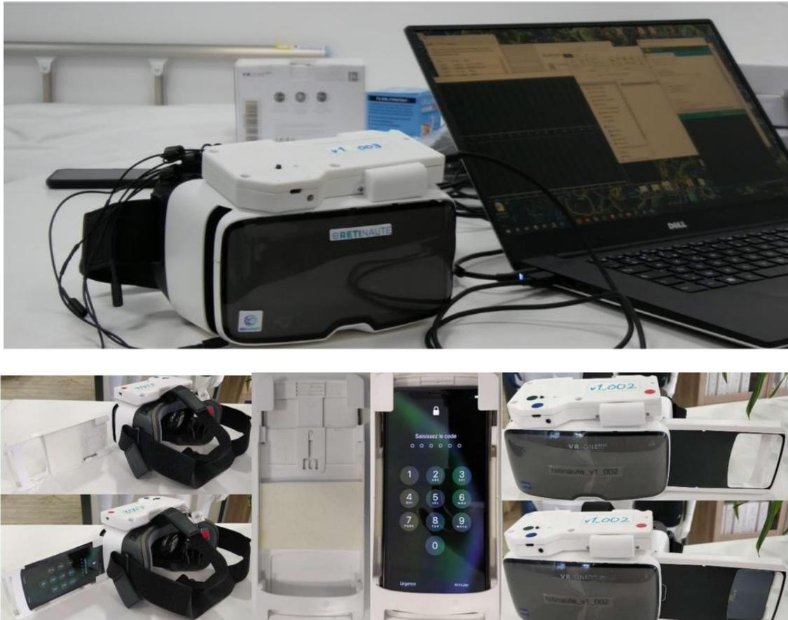
Le Retinaute<sup>®</sup> est connecté à un ordinateur portable par une connexion Bluetooth. L'ordinateur est connecté à un routeur qui fournit une connexion Internet. Le PC dispose de 3 applications :
