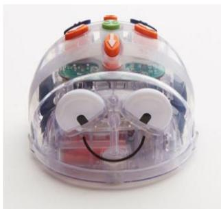
2. BLUE-BOT (Greff, 2016), qui rappelons-le, est un robot éducatif qui se déplace sur le sol (voir **Figure 44**). Il avance et recule en ligne droite par pas de 15 cm et peut pivoter à 90°. Il peut être programmé et piloté à l'aide de sept commandes disposées sur son dos. Quatre Blue-bots ont été apportés avec un tapis quadrillé pour chacun, ainsi que des images imprimées et plastifiées utilisées pour l'activité.
