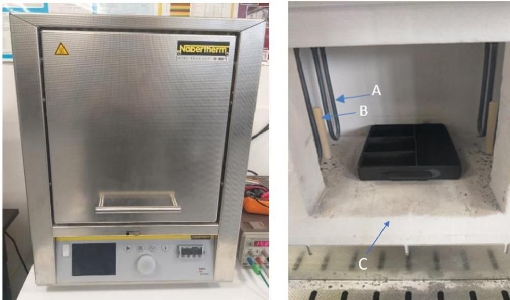
**Figure 2.16: Four utilisé pour le traitement thermique des échantillons testés avec le support en acier-inoxydable. A : Éléments chauffants en disiliciure de molybdène (MoSi<sub>2</sub>) ; B : Thermocouple ; C : chambre du four avec une isolation en matériau fibreux.**
