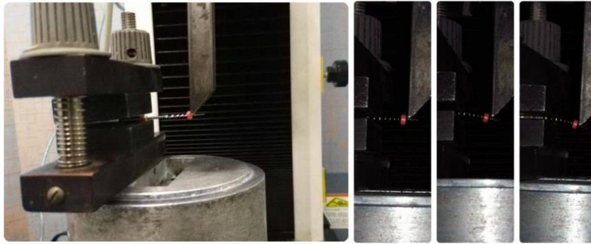
**Figure 1.21** L'essai de flexion « cantilever » (Ismail et al., 2020).
