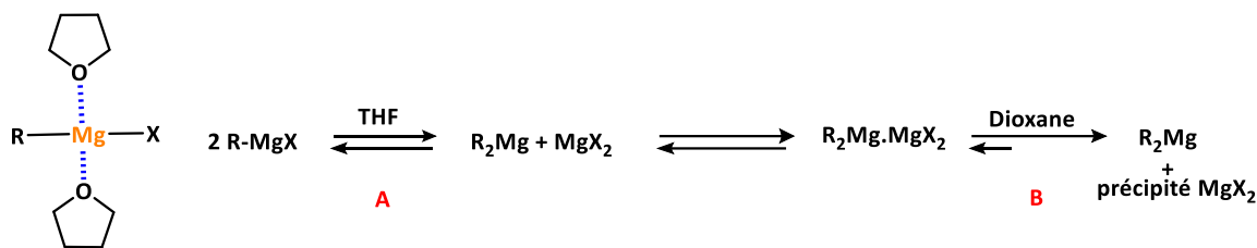
Schéma 16 : Équilibre de Schlenk (A) et déplacement de l'équilibre vers [\text{R}_2\text{Mg}] par ajout de dioxane.
