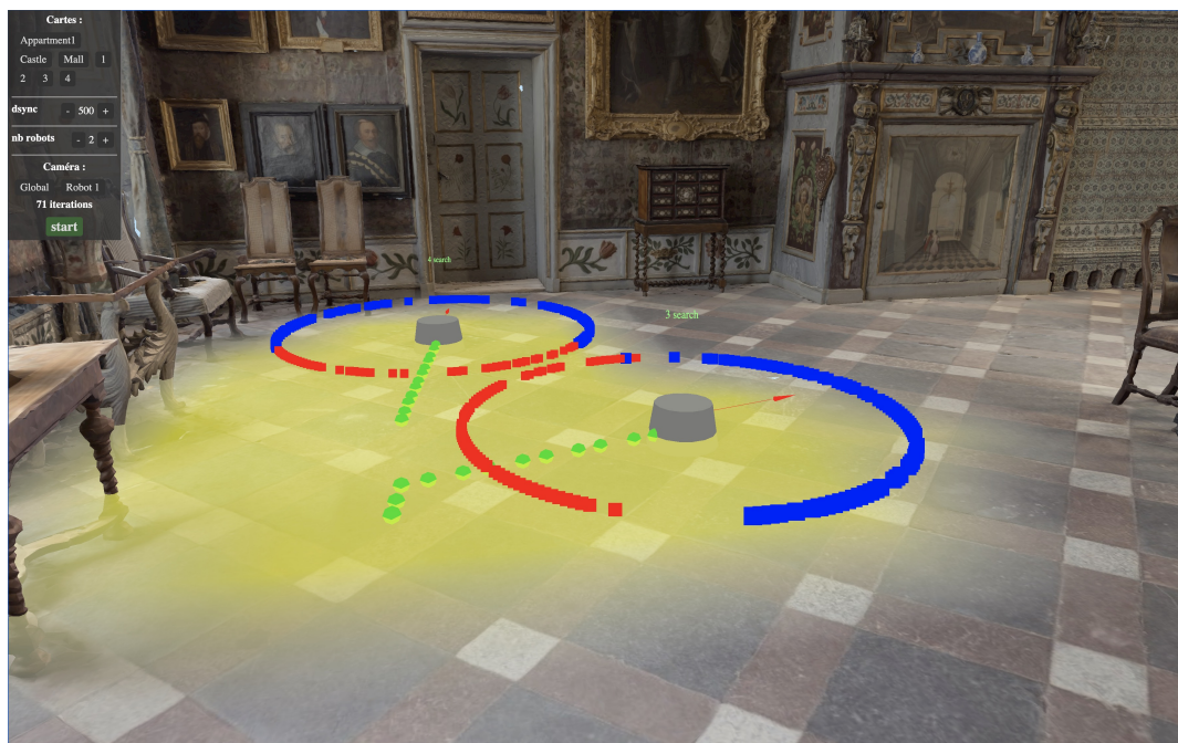
FIGURE 5.2 – Simulateur 3D développé pendant la thèse sur une carte utilisée avec Habitat Sim, réalisée à partir d'un lieu réel scanné.
