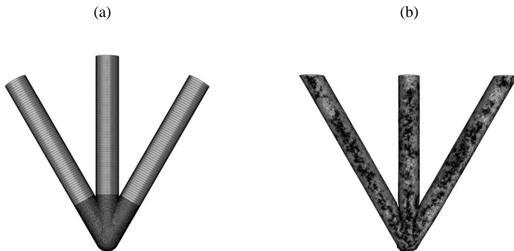
Figure 3.7: structure du maillage considéré pour les simulations par MFN pour la géométrie “idéale” (a) et pour la géométrie “réelle”
