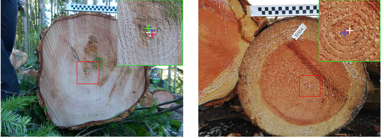
FIGURE 4.16 – Deux exemples où notre méthode n’arrive pas à moins de 5 mm de la vérité terrain. La vérité terrain est la croix blanche, la croix verte est le résultat du réseau YOLO v3 [Kurdthongmee, 2020], celle en bleue montre la moelle détectée par [Schraml and Uhl, 2013], et notre méthode est représentée par la croix rouge.
