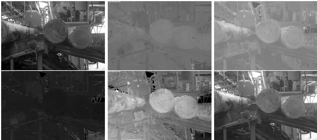
FIGURE 3.17 – Image issue du jeu d’images Sawmill montrant les limites liées à l’image : présence d’une deuxième grume, en première ligne les composantes de l’espace CieLAB et en deuxième ligne les composantes de l’espace HSV.
