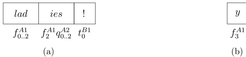
FIGURE 5.7 – Exemple d’une séquence LogootSplit . (a) Séquence de valeurs associées à leur position. (b) Valeur supprimée associée à sa position.
