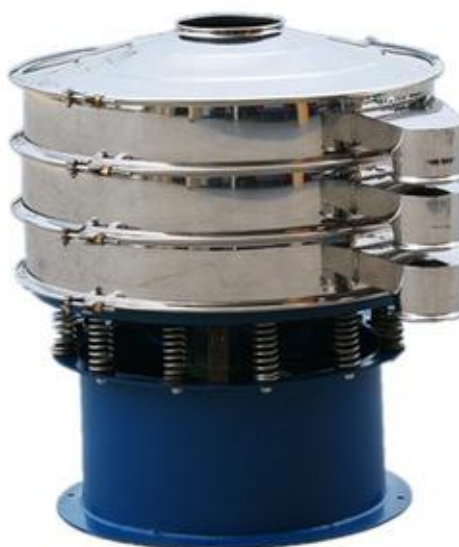
Figure 46 : Une tamiseuse industrielle
