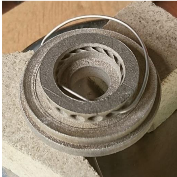
Figure 101 : Photographie du distributeur avec le thermocouple avant d'être soumis à la température.
