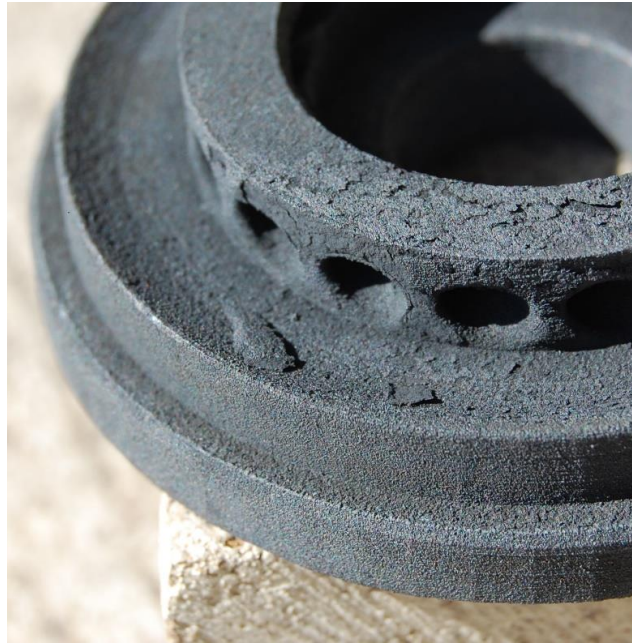
Figure 104 : Photographie du distributeur après 48h à 1150°C.
