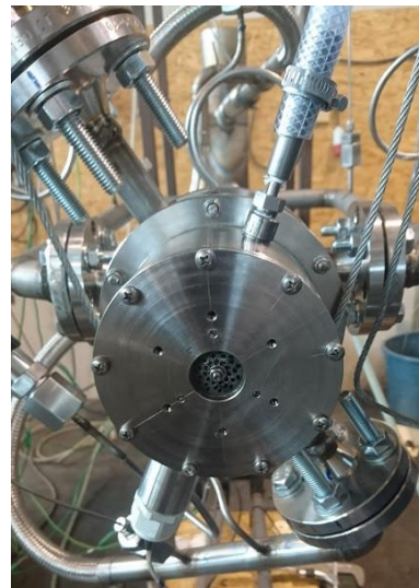
Figure 123 : Micro-turbine AGATCO dans son carter monté sur le banc d'essai.
