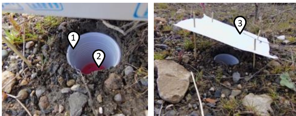
Figure 2.14 : Photographie d'un dispositif d'échantillonnage de la macrofaune épigée par pot piège. [1]: pot en plastique ; [2]: solution d'éthylène-glycol, [3]: toit de protection.
