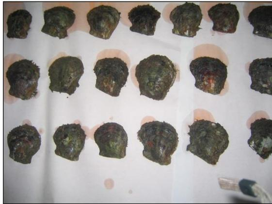
**Figure 45.** Egouttement des échantillons sur un papier filtre
