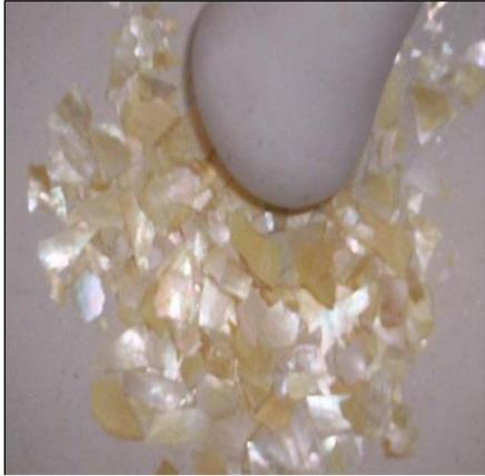
**Figure. 50** Opérations de broyage à l'aide d'un mortier
