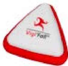
(a) Capteur accélérométrique à porter sur le torse.
