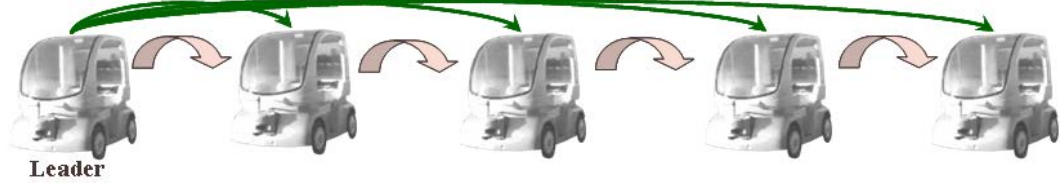
FIGURE 2.12 – Commande longitudinale hybride basée sur les erreurs longitudinales entre un suiveur et le leader du convoi d'une part et un suiveur et son prédécesseur d'autre part (figure tirée de [Bom, 2006]).
