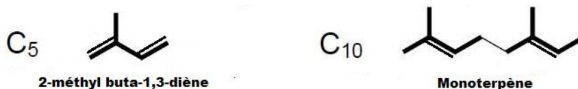
Figure 5 : Structure chimique de l'isoprène (2-méthylbuta 1,3-diène) et d'un terpène
