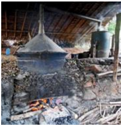
Figure 7 : Alambic traditionnel d'extraction malgache (source : Razafimamonjison et al. 2016)
