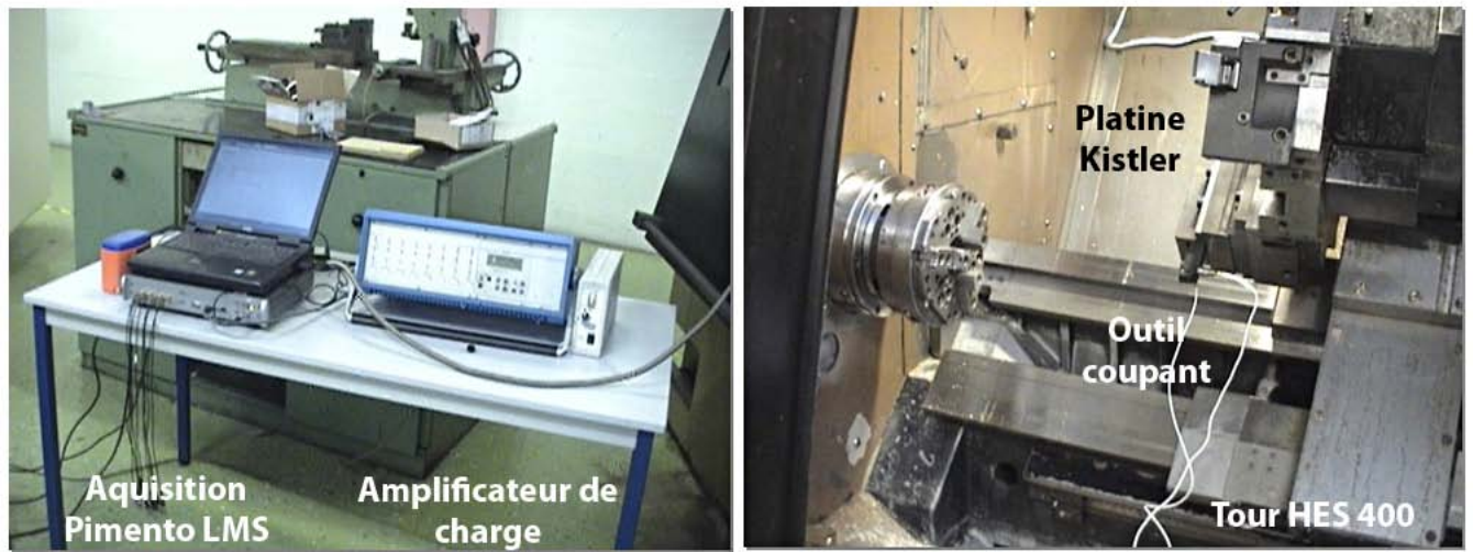
FIG. 2.1: vue du dispositif d'essais en tournage
