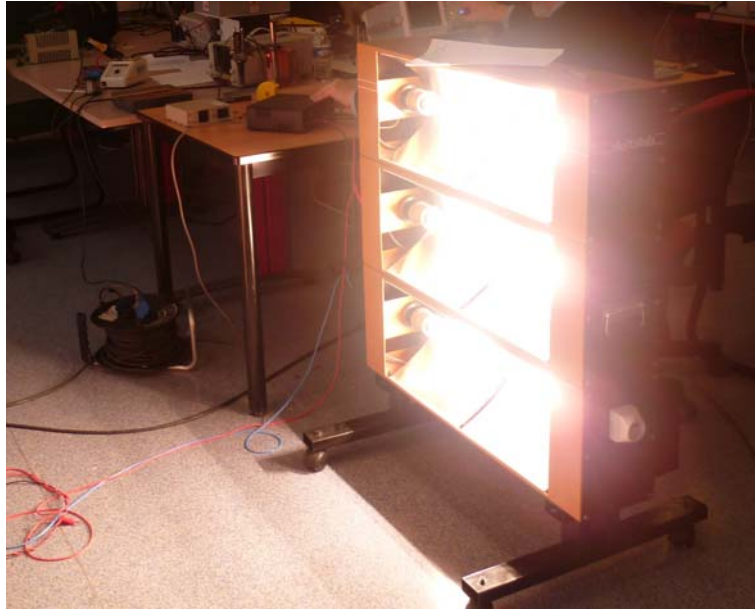
FIGURE 5.32 – Matériel Deltalab équipé de 6 lampes halogènes de 6kW utilisé pour l'illumination en éclairage artificiel.
