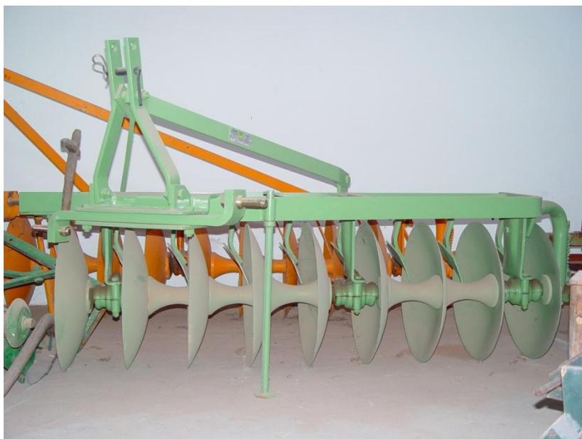
Photo 3. Illustration d'une charrue à disque
