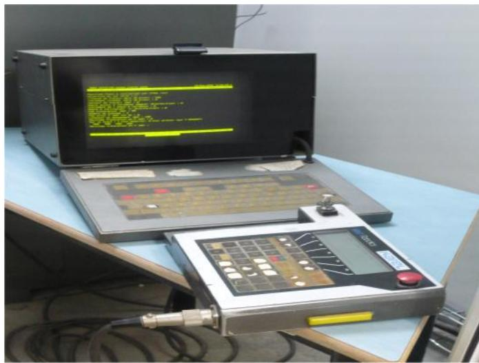
**Figure I-8 : a) Panel de contrôle et de pilotage du générateur et du robot**
