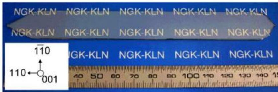
**Fig. I.17** Plaquette de KLN obtenue par la technique  $\mu$ -PD [Ima-2007]
