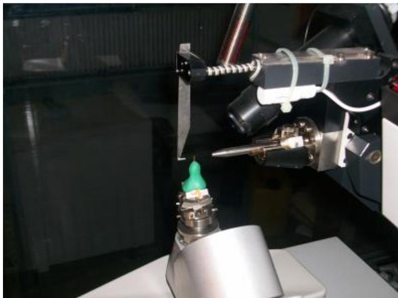
**Fig II.8:** Goniomètre quatre cercles Kappa équipé d'une caméra CCD
