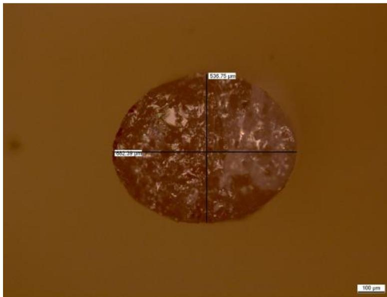
**Fig IV.4:** Section transversale d'une fibre de  $Ca_5(BO_3)_3F$
