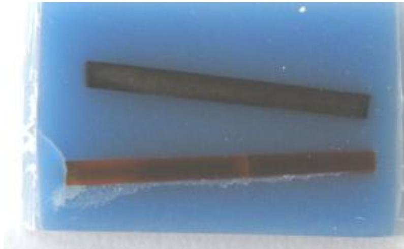
**Fig V.11:** *Fibres de BZBO après traitement thermique sous  $H_2/N_2$*
