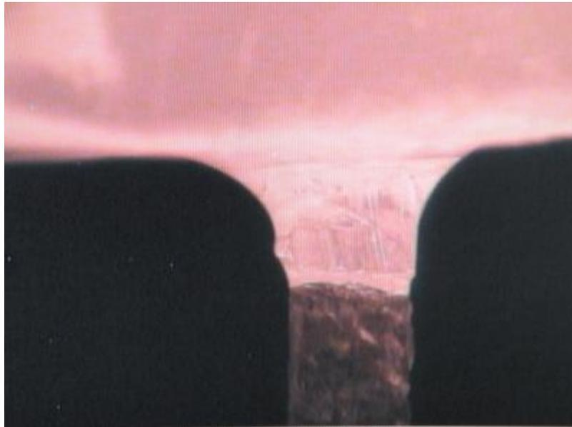
**Fig IV.2:** Fibre de Ca<sub>5</sub>(BO<sub>3</sub>)<sub>3</sub>F en cours de croissance
