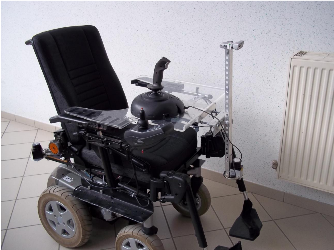
Figure 2.16: Fauteuil VAHM avec le joystick à retour d'effort SideWinder2.
