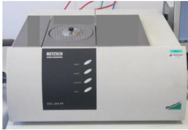
*Fig. 2.17 : Calorimètre différentiel à balayage (DSC) 204 F1 Phoenix<sup>®</sup> de Netzsch.*
