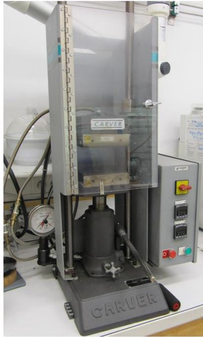
*Fig. 2.9 : Presse Carver à refroidissement hydraulique.*
