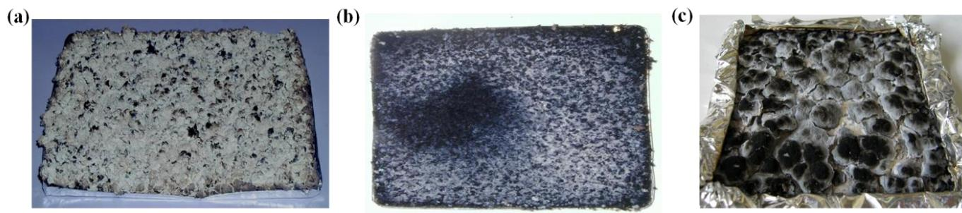
Fig. 3.18 : Clichés après les tests au cône calorimètre : PMMA-15%  $TiO_2$  (a) [6],
