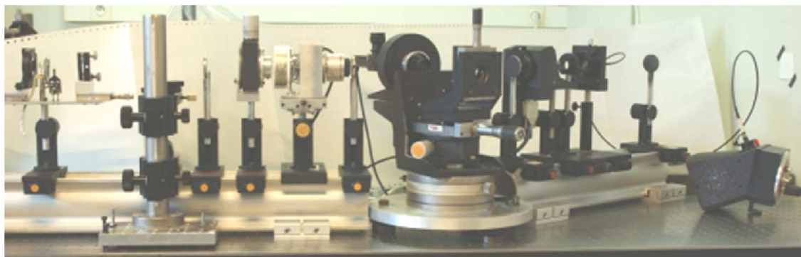
FIGURE 2.10 – Ellipsomètre spectroscopique temps réel à compensateur tournant.
