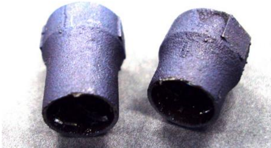
Figure III-37 : Image d'une éprouvette tubulaire cassée après un essai de fatigue
