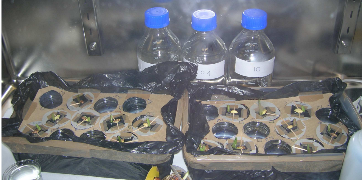
Figure 12 : dispositif d'exposition des plantes aux nanoparticules
