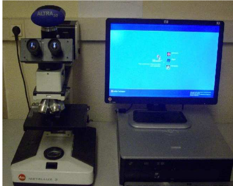
Figure II.5 : Le microscope optique utilisé pour visualiser la microstructure et la taille des grains
