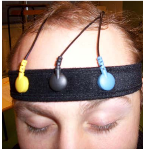
FIGURE 3.4 – Emplacement du capteur du signal EMG
