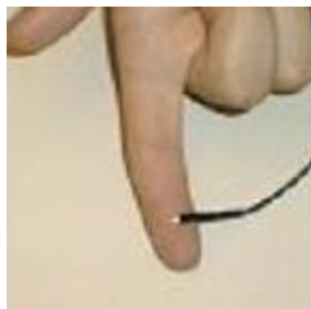
FIGURE 3.10 – Emplacement du capteur de température cutanée
