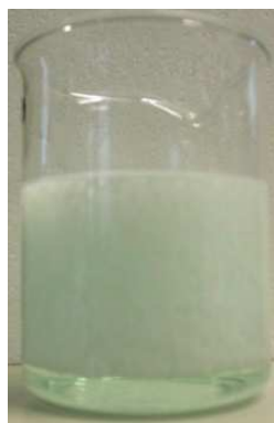
Figure 35 : Précipité de \text{Cd}(\text{C}_9)_2 obtenu à partir d'un mélange \text{Cd}^{2+} / \text{Ni}^{2+}
