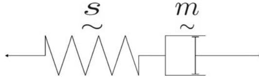
FIG. 1.17 – Modèle série de Maxwell
