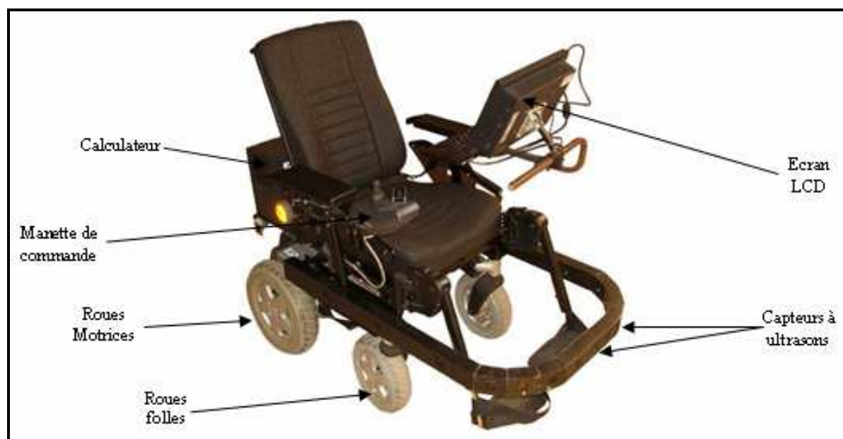
Figure II.3 : Fauteuil roulant électrique 'Storm' instrumenté.
