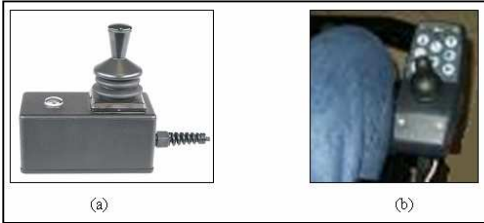
Figure II.6 : (a) joystick utilisé sur le simulateur; (b) joystick monté sur le fauteuil réel.
