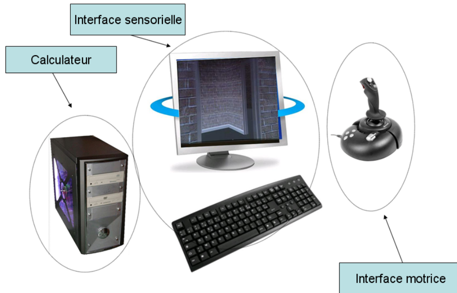
Figure 3.4 : Système de simulation minimal, constitué d'un ordinateur relié à une interface sensorielle (ici moniteur) et d'une interface motrice (ici joystick)
