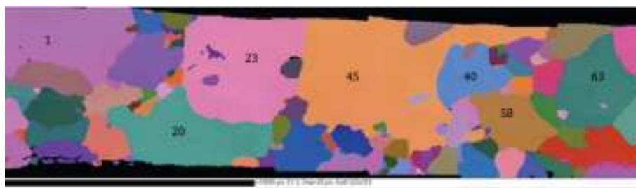
Figure V- 2 : Cartographie EBSD de la partie utile de l'éprouvette après traction
