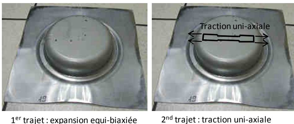
Figure 2.7 Essai d'expansion equi-biaxée / traction uni-axiale.
