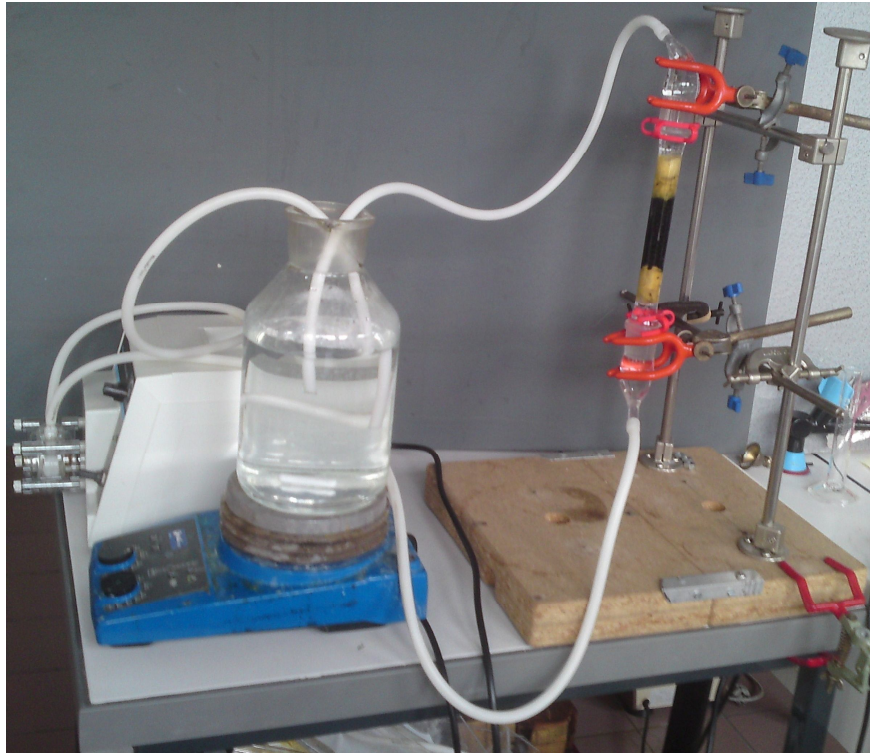
Figure III. 14 : Dispositif expérimental de l'adsorption sur charbon actif effectué au laboratoire (2L de solution de Diuron à 10 mg/L) pendant 4 heures en recirculation (boucle).
