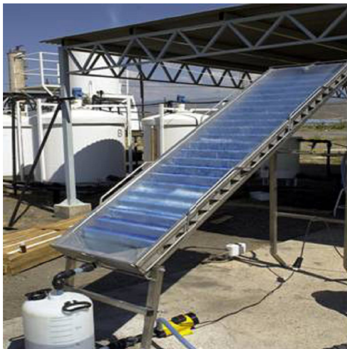
Figure I. 8: collecteur à non-concentration de type cascade utilisant le catalyseur supporté Ahlstrom (plate forme solaire d'Almeria, Espagne) 44
