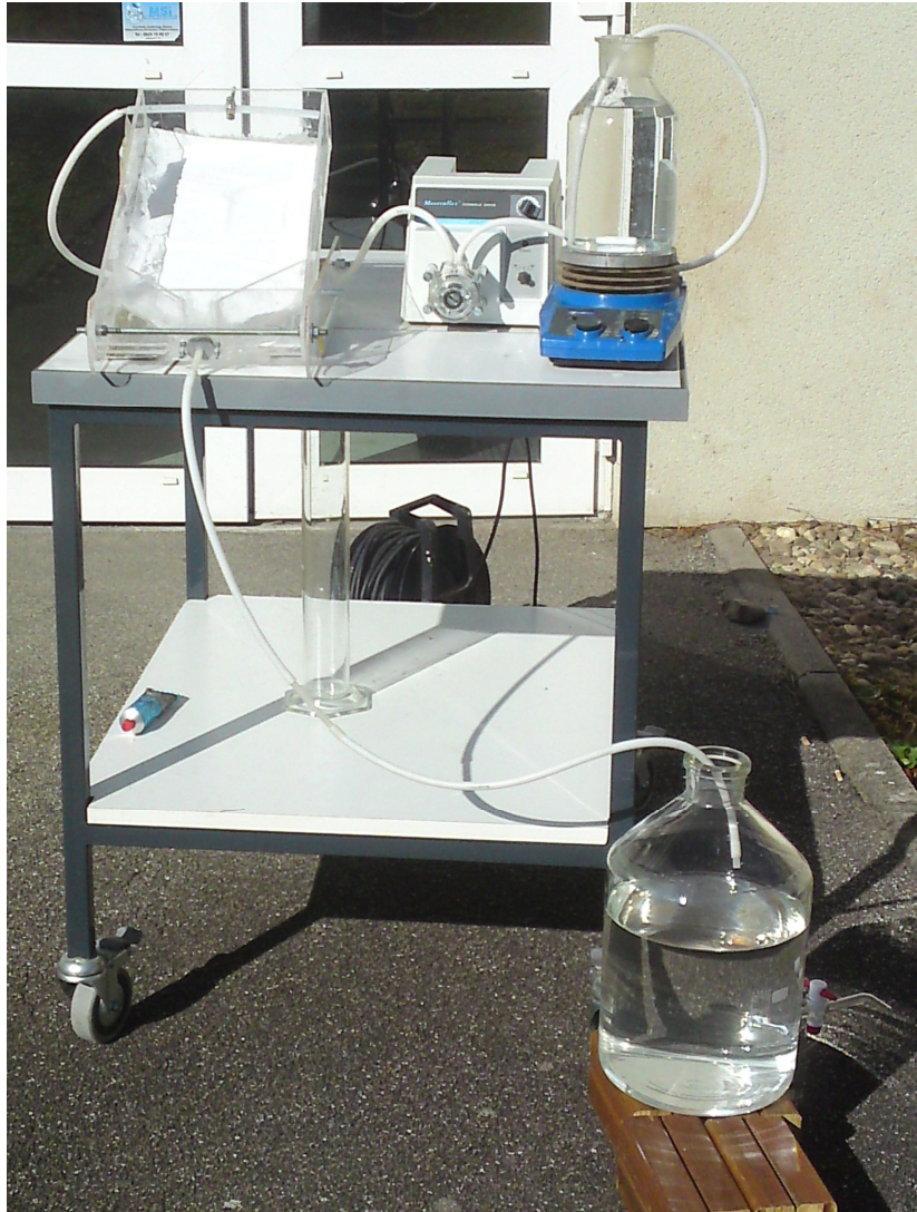
Figure III. 3 : Dispositif expérimental utilisé pour les tests photocatalytiques effectués sur le petit réacteur simple (r).
