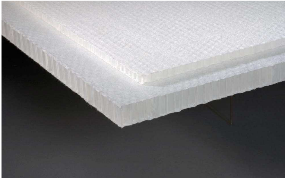
Figure 2.2 Structure en nid d'abeille polypropylène
