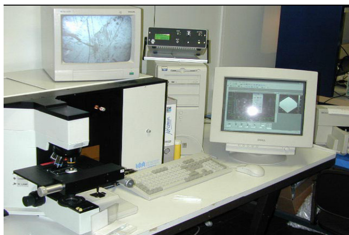
Figure 2.25 : Le Micro-Raman du LMOPS, LABRAM 010 (Jobin-Yvon).
