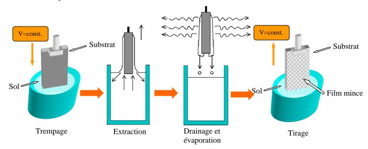
**Figure 21 :** Détail des étapes du dip-coating : Trempage du substrat dans le sol, formation de la couche pendant le retrait du substrat et gélation du film par évaporation du solvant
