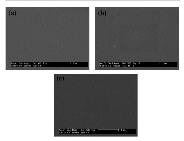
**Figure 55 :** Photos MEB de films de TiO<sub>2</sub> déposés sur des barrières de diffusion d'épaisseur (a) 25 nm, (b) 75 nm et (c) 150 nm
