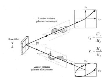
Figure 32 : Principe de l'ellipsométrie
