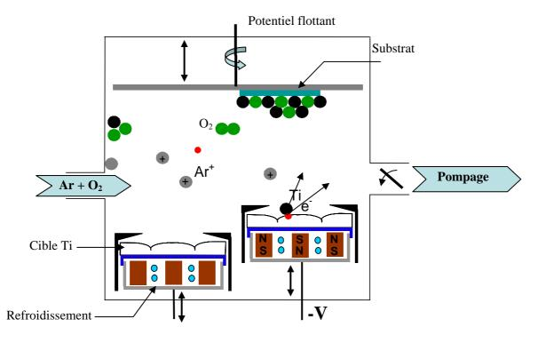
Figure 26 : Dispositif de pulvérisation cathodique type magnétron (dépôt de film TiO<sub>2</sub>)
