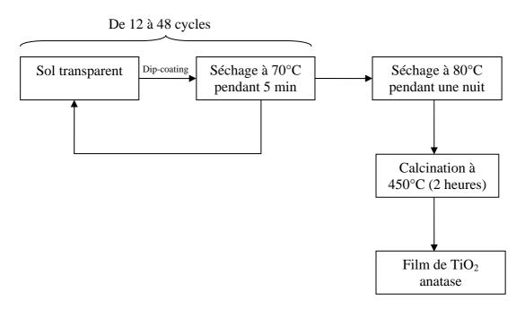
Figure 28 : Protocole de dépôt de films de TiO<sub>2</sub>
