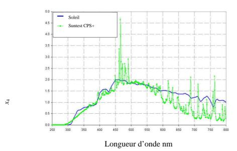
**Figure 38 :** Comparaison entre le spectre distribution spectral d'émission du soleil et la lampe à Xénon du simulateur (Atlas Suntest CPS+)
