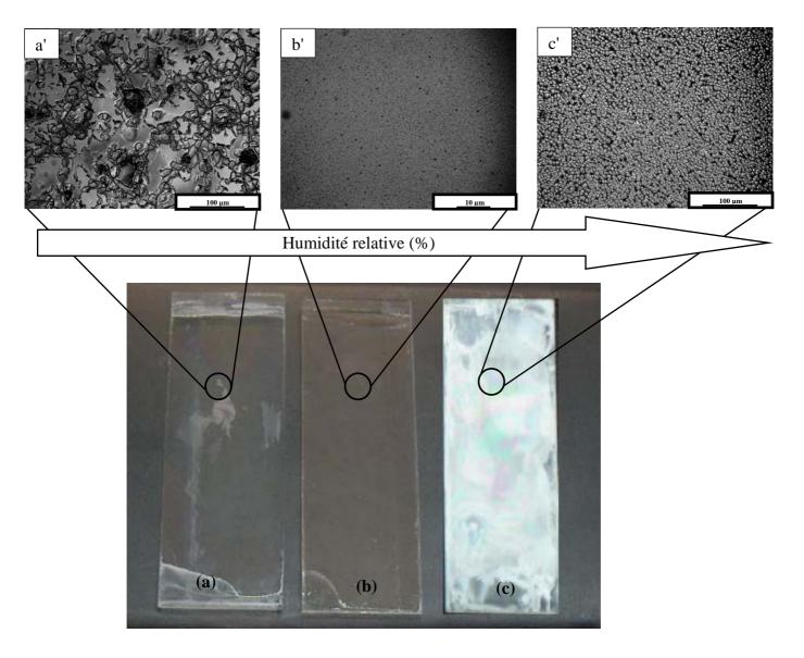
**Figure 29:** Photos de l'apparence visuel (a, b, c) et de microscopie optique (a', b', c') des films  $TiO_2/VSC$  obtenus par sol-gel à différent taux d'humidité présent dans la chambre, (a, a') < 10%; (b, b') 35-50% et (c, c') > 70%
