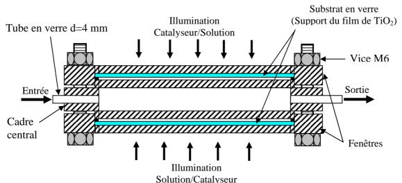
Figure 36: Schéma représentant une coupe transversale du photoréacteur
