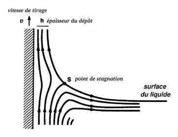
Figure 22 : Aspect physique du dépôt du film par « Dip-coating » (BRI, 1990)
