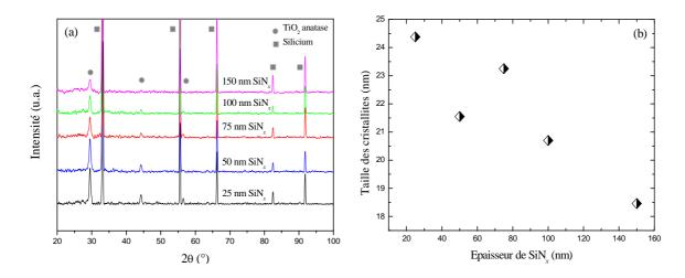
**Figure 56 :** (a) spectres DRX des films  $TiO_2$  déposés sur différentes épaisseurs de  $SiN_x$  et (b) évolution de la taille des cristallites de  $TiO_2$  en fonction de l'épaisseur de la barrière de diffusion
